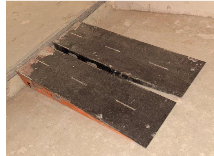
Kovové klíny pro nájezd mezi plochami s různou výškou
